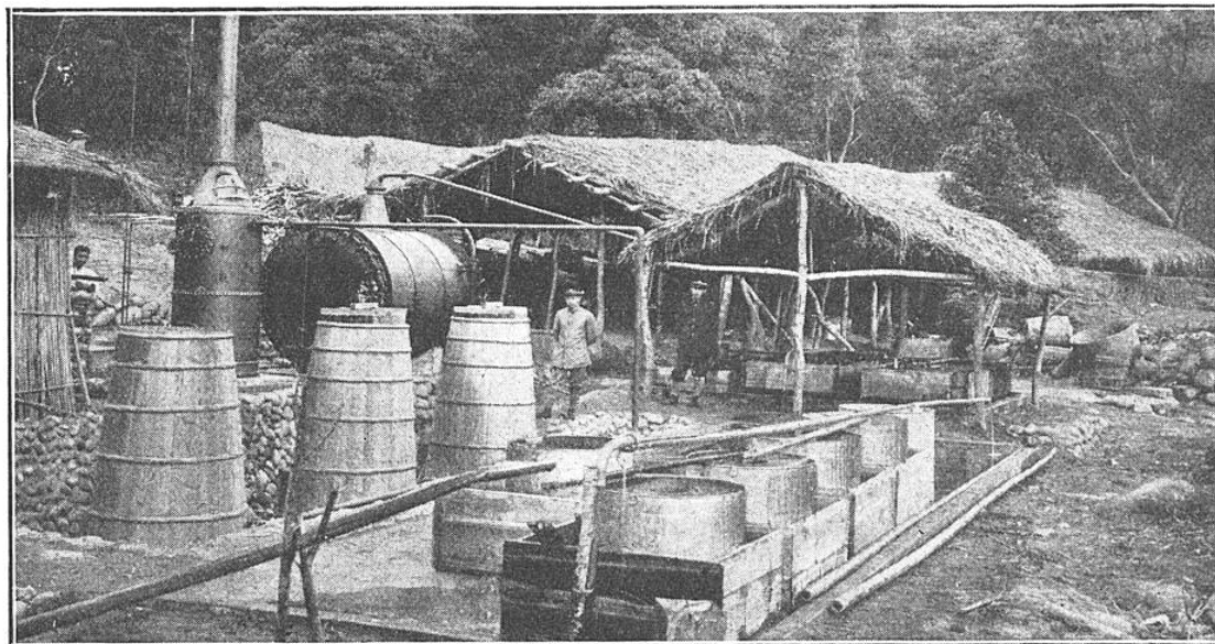
INSTALLATION MODERNE POUR L'OBTENTION DU CAMPBRE PAR DISTILLATION DE COPEAUX DE CAMPHRIER DANS LES FORÊTS DE L'ÎLE DE FORMOSE
