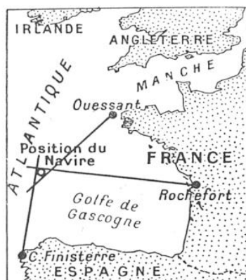
FIG. 14. — COMMENT REPÉRER PAR RADIOGONIOMÈTRES À TERRE LA POSITION D'UN NAVIRE
