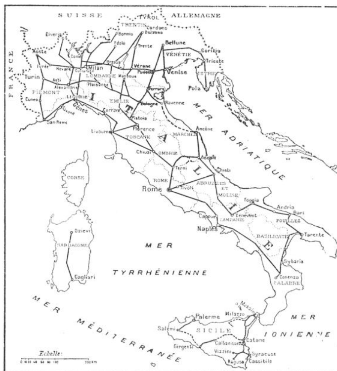
FIG. 3. — ENSEMBLE DES LIGNES ITALIENNES DE TRANSPORT D'ÉNERGIE ÉLECTRIQUE
