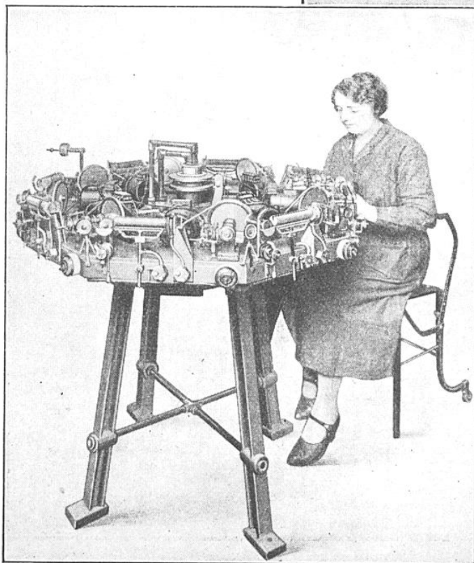
FIG. 5. — LA PRÉPARATION DES FILS DE TUNGSTÈNE
