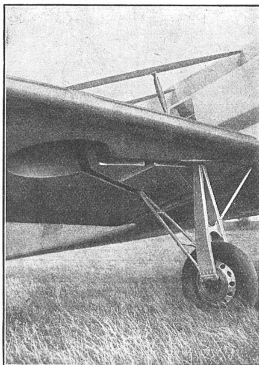
FIG. 6. — LE TRAIN D'ATERRISSAGE ESCAMOTABLE DU « BLÉRIOT »
