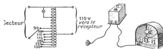
FIG. 6. — LE SURVOLTEUR-DÉVOLTEUR PERMET DE MAINTENIR CONSTANTE LA TENSION D'ALIMENTATION DU POSTE
