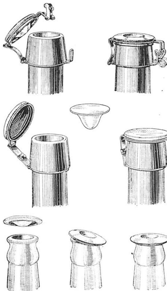
LES TROIS SYSTÈMES DE BOUCHAGE AUTOMATIQUE DES BOUTEILLES
