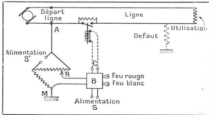
FIG. 5. — SCHÉMA DU DISPOSITIF CHAUVIN ET ARNOUX PERMETTANT DE MESURER PÉRIODIQUEMENT L'ISOLEMENT D'UN CIRCUIT ÉLECTRIQUE ET D'EN DÉCELER LES DÉFAUTS La résistance d'isolement de la ligne forme la quatrième branche du pont M, alimenté par S'. Un circuit C commande un contacteur qui permet de vérifier la ligne à intervalles déterminés. Le feu rouge s'allume dès que l'isolement est défectueux.
