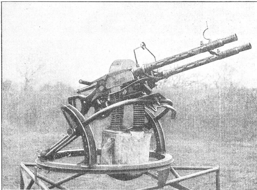
FIG. 6. — TOURELLE D'AVION COMPORTANT DEUX MITRAILLEUSES JUMELÉES DE 20  $\frac{m}{m}$
