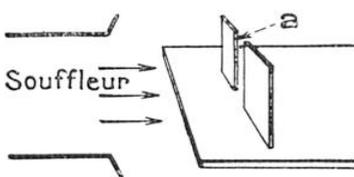
En haut : l'effet photographié sur un courant liquide (on distingue la fente un peu en dessous du bord supérieur de l'obstacle). — En bas : le même effet, dans l'air. Il a pour conséquence de fournir un accroissement de résistance sur le bord a intérieur de la fente.
