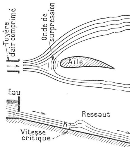
FIG. 3. — UNE ANALOGIE HYDRAULIQUE IMPORTANTE : L'ONDE DE CHOC
