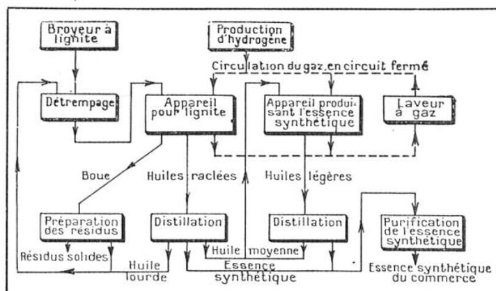
FIG. 11. — PRÉPARATION DE L'ESSENCE SYNTHÉTIQUE PAR HYDROGÉNATION DU LIGNITE
