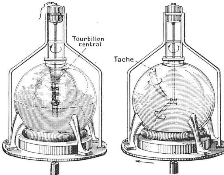
FIG. 10. — COMMENT ON EXPLIQUE LA FORMATION DES TACHES SOLAIRES AU MOYEN DES TOURBILLONS
