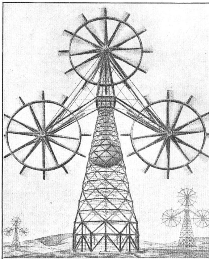
FIG. 3. — PROJET DE TOUR TOUT ACIER DE 500 MÈTRES DE HAUT PORTANT SIX ROUES DE 160 MÈTRES DE DIAMÈTRE COUPLÉES PAR PAIRES ET Tournant en sens inverse. Les extrémités des aubes des immenses roues atteignent une vitesse de 325 km-heure, et le poids total de l'installation est de 5.000 tonnes environ. Les pôles des générateurs sont disposés en couronne sur les roues (voir fig. 6).
