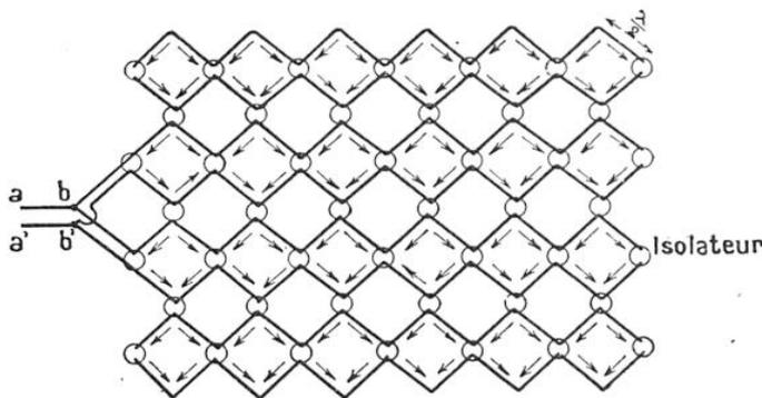
FIG. 7. — SCHÉMA D'ANTENNE EN RIDEAU POUR L'ÉMISSION D'ONDES COURTES DIRIGÉES
