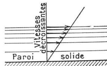
FIG. 5. — L'EFFET DE LA VISCOSITÉ DANS L'ÉCOULEMENT D'UN « FLUIDE IMPARFAIT »
