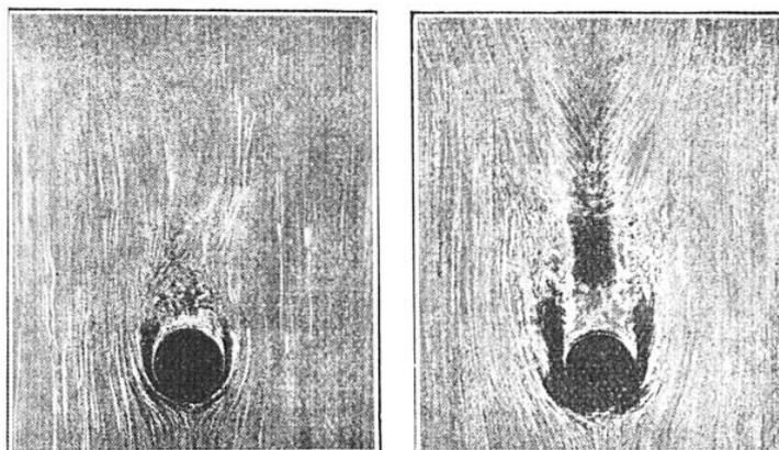
FIG. 7. — L'EFFET DE « TURBULENCE » D'UN COURANT HYDRAULIQUE AROUND D'UN OBSTACLE
