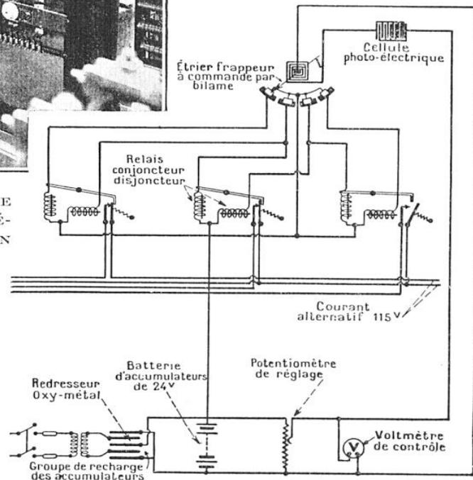
FIG. 7. — LE SCHÉMA DES RELAIS COMMANDANT L'ÉCLAIRAGE DU SOUTERRAIN DE L'AVENUE FOCH (PARIS)
