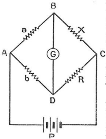
FIG. 4. — PONT DE WHEATSTONE POUR LA MESURE DES RÉSISTANCES X, résistance à mesurer; a, b, résistances fixes; R, résistance réglable; P, pile. On règle la résistance R pour que le galvanomètre G reste au zéro. La résistance X est donnée, en fonction de a, b, R, par une formule très simple.
