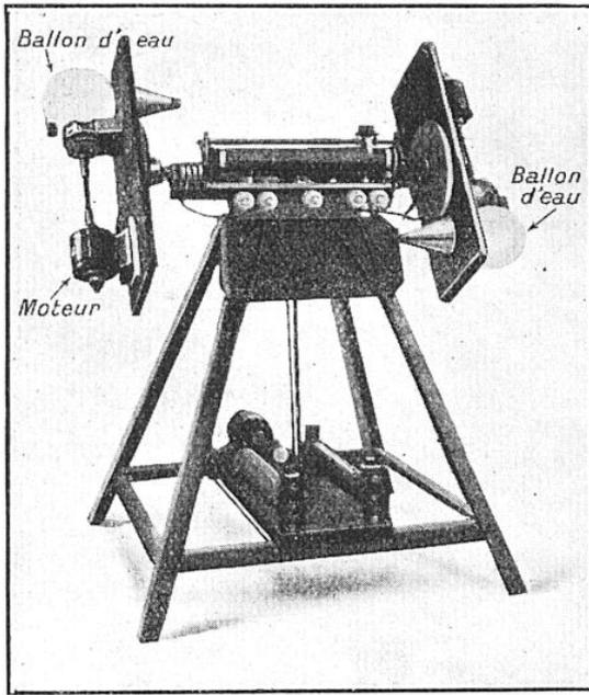
FIG. 12. — AUTRE APPAREIL METTANT EN RELIEF LA COMPOSITION DES TOURBILLONS AVEC LA ROTATION DU MILIEU QUI LES CONTIENT (Voir schéma figure 13.)
