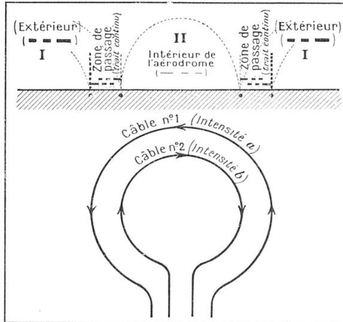
FIG. 7. — LA FONCTION DES DEUX CABLES CIRCULAIRES EXTÉRIEURS DE L'AÉRODROME
