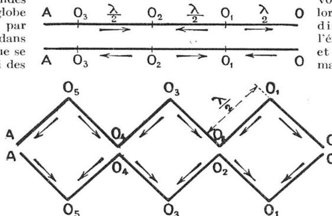
FIG. 4. ET 5. — SYSTÈME D'ONDES STATIONNAIRES LE LONG D'UNE LIGNE DE DEUX FILS ET PROVENANT DE L'INTERFÉRENCE D'ONDES ENVOYÉES DE A VERS O ET RÉFLÉCHIES A L'EXTRÉMITÉ O DE LA LIGNE
