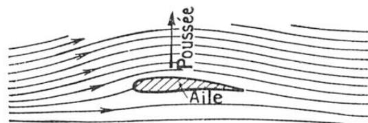
FIG. 2. — ÉCOULEMENT DE L'AIR AUTOUR D'UNE AILE FUSELÉE, AUX PETITES VITESSES. Les « filets » suivent presque les lois du « fluide parfait » et épousent la forme de l'aile.
