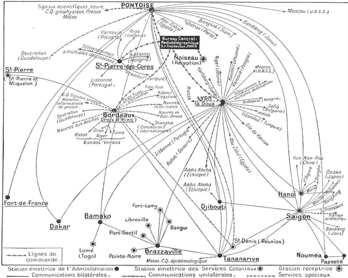
FIG. 9. — CARTE DE L'ENSEMBLE DES COMMUNICATIONS RADIOÉLECTRIQUES FRANÇAISES (RÉSEAU RADIOTÉLÉGRAPHIQUE DE L'ADMINISTRATION DES P. T. T.)
