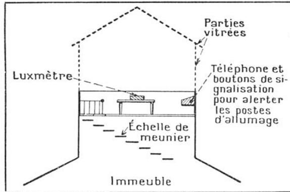
FIG. 8. — SCHÉMA DU POSTE ÉTABLI A BERLIN POUR PERMETTRE A UN OBSERVATEUR DE SURVEILLER QUANTITATIVEMENT L'ÉCLAIRAGE DE LA VILLE EN FONCTION DE LA CLARTÉ DIURNE
