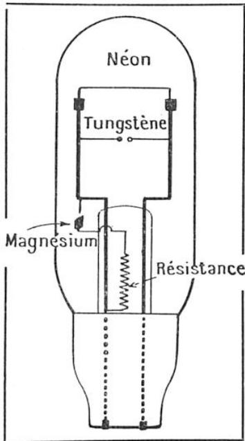
SCHÉMA DE LA LAMPE « PAIN-TOLITE » A ARC ÉLECTRIQUE EN ATMOSPHÈRE GAZEUSE
