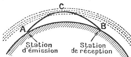
FIG. 1. — ENTRE LA STATION D'ÉMISSION ET LA STATION DE RÉCEPTION, LES RAYONS DE FORCE ÉLECTRIQUE SUIVENT LE TRAJET COURBE A C B
