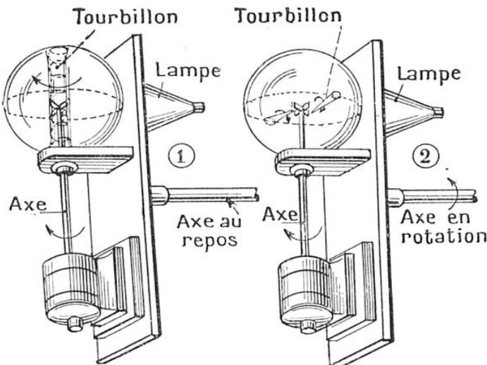
FIG. 13. - AUTRE EFFET DE FORMATION DE TOURBILLONS Ici, le tourniquet est au centre du ballon. Le tourbillon central prend une position perpendiculaire à l'axe du tourniquet qui lui a donné naissance (schéma de droite).
