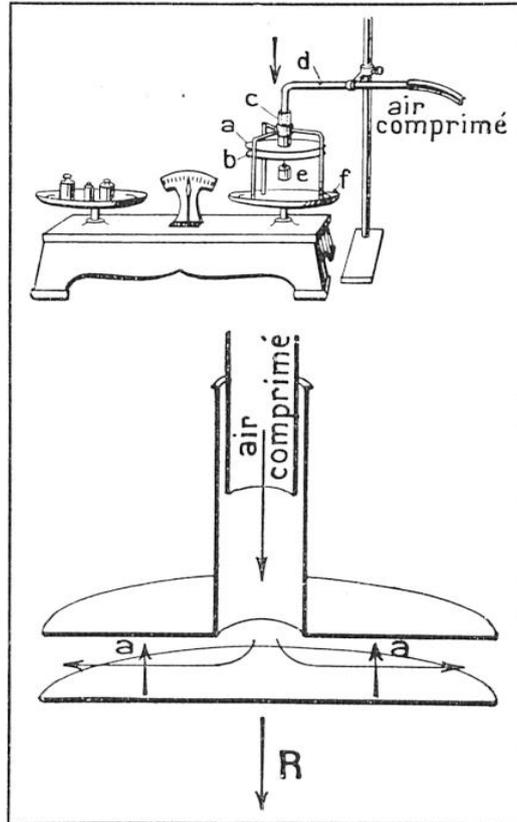
FIG. 16. — UN PARADOXE DONT LE GRAND PHYSICIEN BERNOULLI A CEPENDANT FOURNI L'EXPLICATION MATHÉMATIQUE. En haut : un courant d'air comprimé est lâché sur un dispositif à deux plateaux indépendants (détailé en bas). Au lieu de repousser le plateau inférieur, l'air comprimé provoque son ascension vers le plateau supérieur, tandis que l'ensemble des deux plateaux est repoussé vers le bas, comme l'indique finalement la balance.
