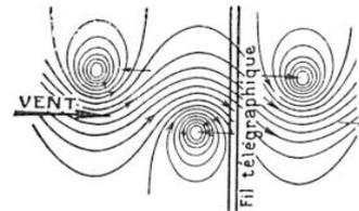
FIG. 9. — UNE « ALLÉE DE TOURBILLONS » PASSANT SUR UN FIL TENDU LE FAIT VIBRER
