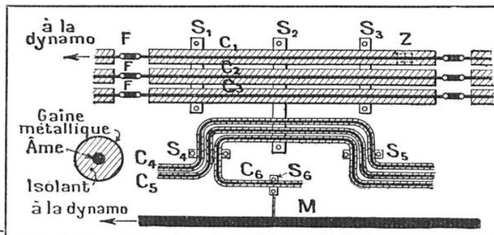
FIG. 3. — SCHÉMA DE L'EXPÉRIENCE DE M. OTTO SUR L'ISOLEMENT DES LIGNES
