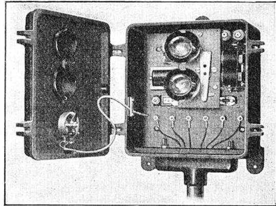
FIG. 7. — L'APPAREIL DE DÉTECTION OUVERT MONTRANT LES DEUX LAMPES, BLANCHE ET ROUGE, SIGNALANT L'ÉTAT DE LA LIGNE
