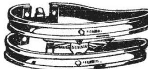
Montage avec ferrures ; lorsqu'il est impossible de monter le pare-chocs à l'aide de supports, on emploie des ferrures spéciales se fixant directement au châssis. Ces ferrures sont comprises dans le prix des pare-chocs, sauf pour le cas où leur exécution nécessiterait un travail particulier, qui serait à faire d'après devis.
