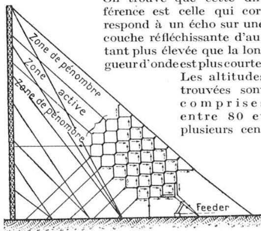
FIG. 6. — ANTENNE EN RIDEAU, POUR ONDES DE 24 M 46, SOUTENUE PAR UN SEUL PYLONE (CENTRE DE SAINTE-ASSISE).
