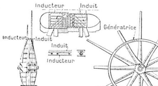
FIG. 5. — DÉTAILS D'UNE ROUE ÉOLIENNE MONTRANT LA DISPOSITION DES GÉNÉRATEURS EN COURONNE
