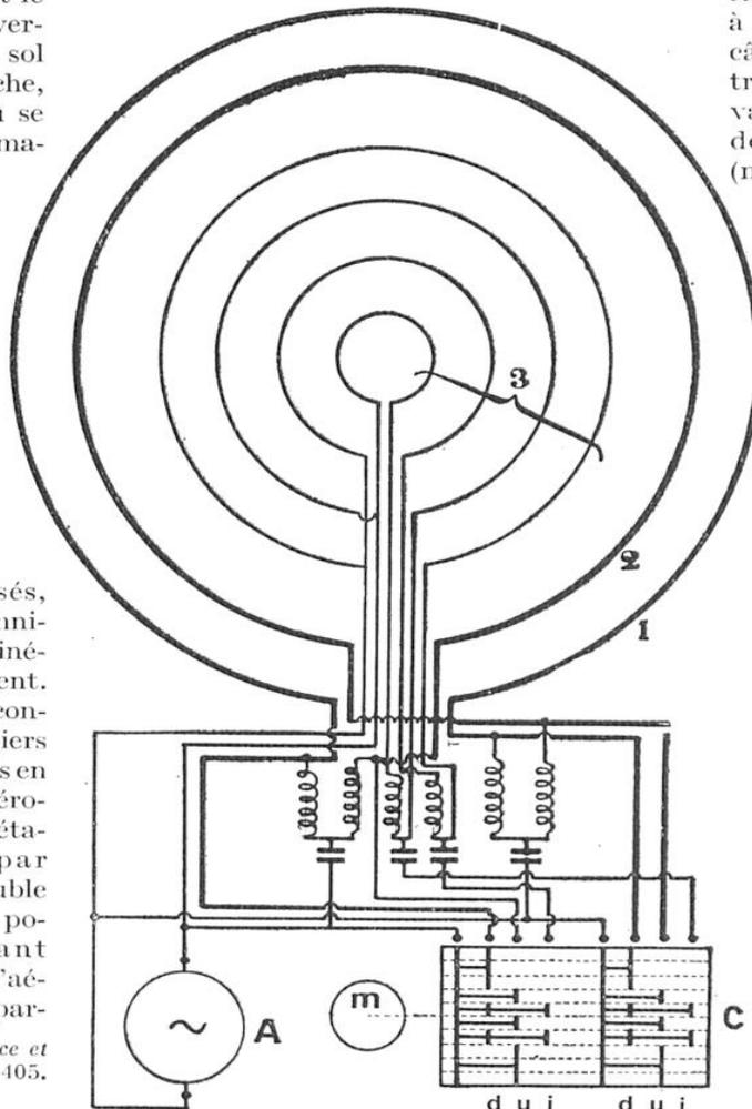
FIG. 9. — L'AÉRODROME (EN PLAN) AVEC SES CABLES DE BALISAGE ÉLECTROMAGNÉTIQUE
