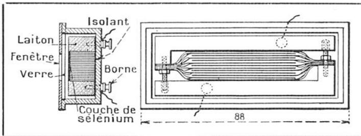
FIG. 4. — SCHÉMA DU MONTAGE DE LA CELLULE « PHOTO-RÉSISTANTE » AU SÉLÉNIUM
