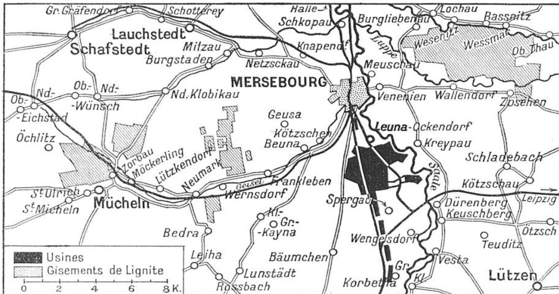
FIG. 1. — PLAN DE SITUATION DES « LEUNAWERKE » ET DES GISEMENTS DE LIGNITE UTILISÉ COMME COMBUSTIBLE ET COMME MATIÈRE PREMIÈRE DES DIVERSES FABRICATIONS. Les usines de la Leuna s'étendent sur une longueur de 4 km 5 et sur une largeur de 2 kilomètres. Elles absorbent 15.000 tonnes de lignite par jour, extraites des gisements environnants.
