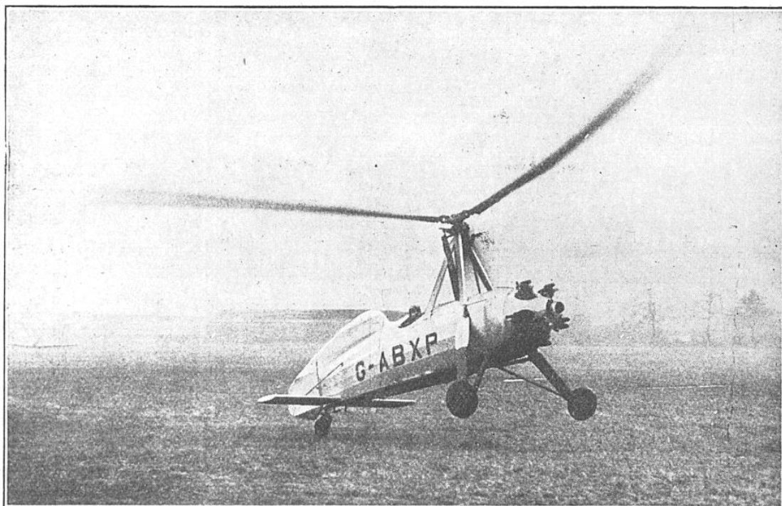
FIG. 6. — LE MODÈLE « C.-L. 10 » (LA CIERVA-LEPÈRE) Le grand plan stabilisateur a disparu. Un seul gouvernail est conservé, celui de direction.
