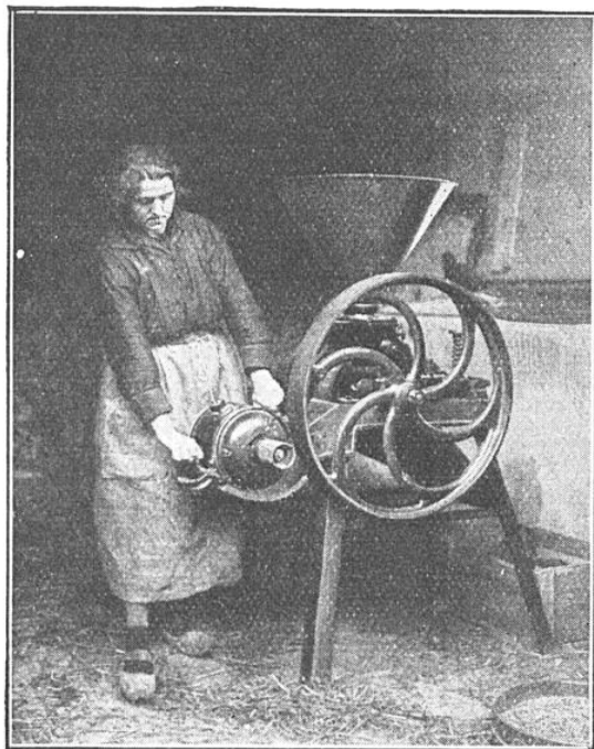
FIG. 5. — COMMENT ON INSTALLE LE MOTEUR DE L'APLATISSEUR DE GRAINS On voit ici la première phase de ce montage.
