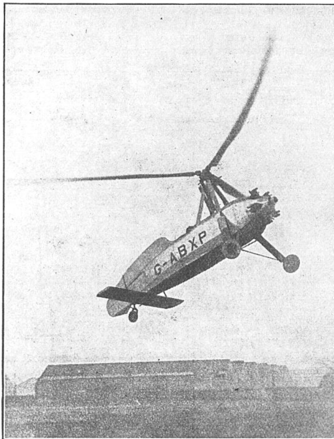
FIG. 9. — L'AUTOGIRE « C.-L. 10 » (LA CIERVA-LEPÈRE) CABRÉ ET VOLANT À SON ANGLE D'ATTAQUE MAXIMUM
