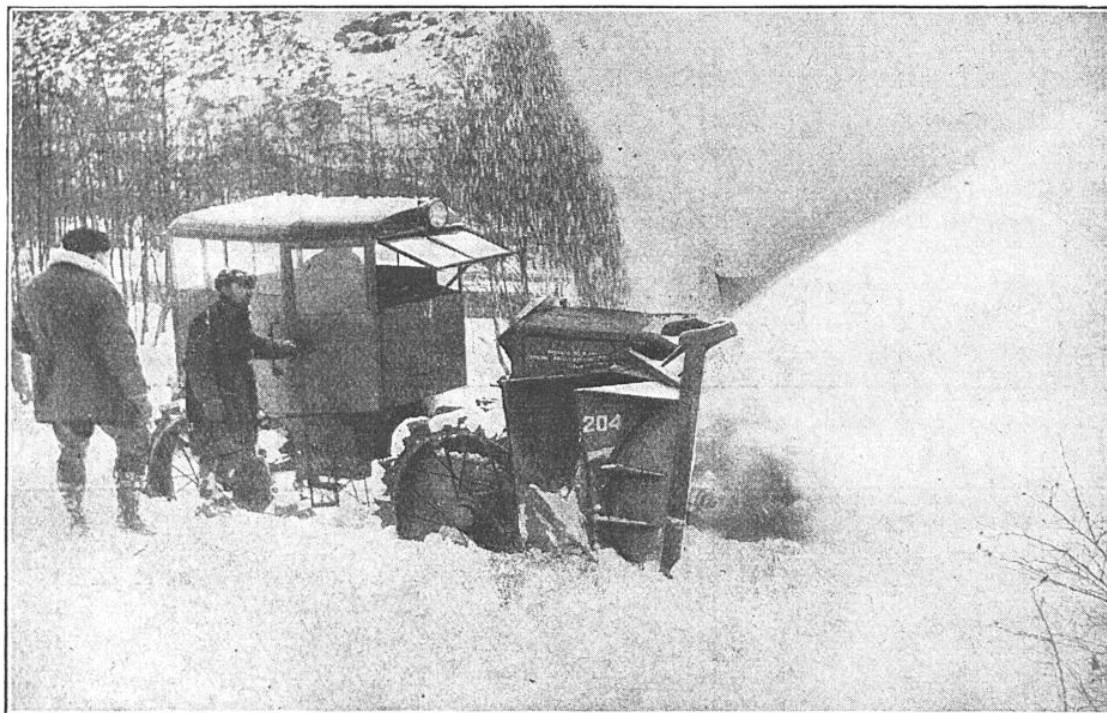
FIG. 8. — CE CHASSE-NEIGE ITALIEN, A TURBINES, REJETTE LA NEIGE A GRANDE DISTANCE DES DEUX CÔTÉS DE LA ROUTE. CET APPAREIL EST A LA FOIS PUISSANT ET LÉGER
