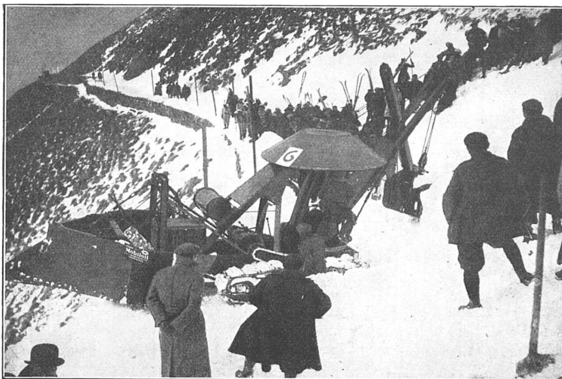
FIG. 9. — CHASSE-NEIGE A ÉTRAVE A L'AVANT, ET A PELLE MÉCANIQUE A L'ARRIÈRE, ATTAQUANT UN MUR DE NEIGE GELÉE AU CONCOURS DE 1933
