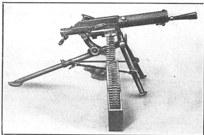
FIG. 5. — LA MITRAILLEUSE « SCHWARZLOSE » Cette mitrailleuse à « culasse non calée » a été utilisée par les armées austro-hongroises pendant la guerre 1914-1918.
