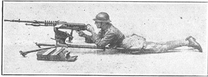
FIG. 4. — LA MITRAILLEUSE FRANÇAISE « HOTCHKISS » Cette mitrailleuse à refroidissement par air est représentée montée sur un affût trépied en position couchée.
