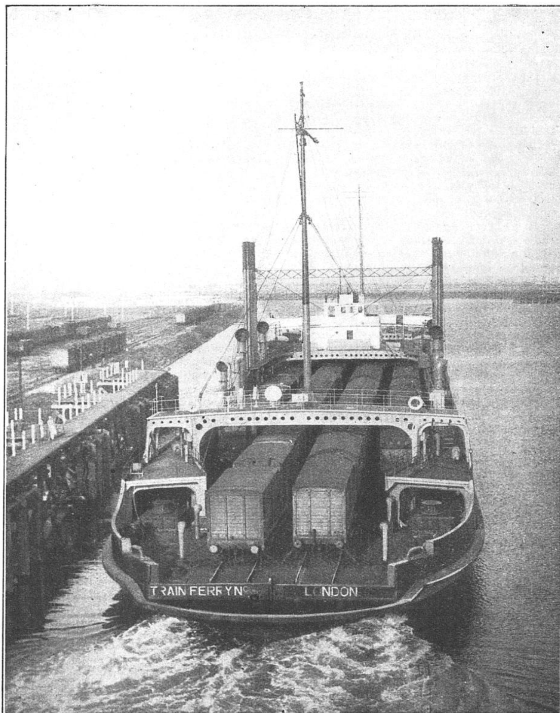
UN SERVICE DE FERRY-BOATS RELIE LA FRANCE A L'ANGLETERRE, ENTRE CALAIS ET HARWICH. C'EST LA PREMIÈRE LIGNE « COMMERCIALE » DE CE GENRE ÉTABLIE ENTRE CES DEUX PAYS. Les ferry-boats franco-anglais sont du type de celui représenté ci-dessus. Ils mesurent 109 mètres de longueur sur 18 mètres de largeur. Leurs machines développent une puissance de 3.200 ch et assurent une vitesse de 12 nœuds (22 kilomètres à l'heure) ; quatre voies, d'une longueur totale de 344 mètres, permettent de transporter 40 wagons complets à chaque voyage.
