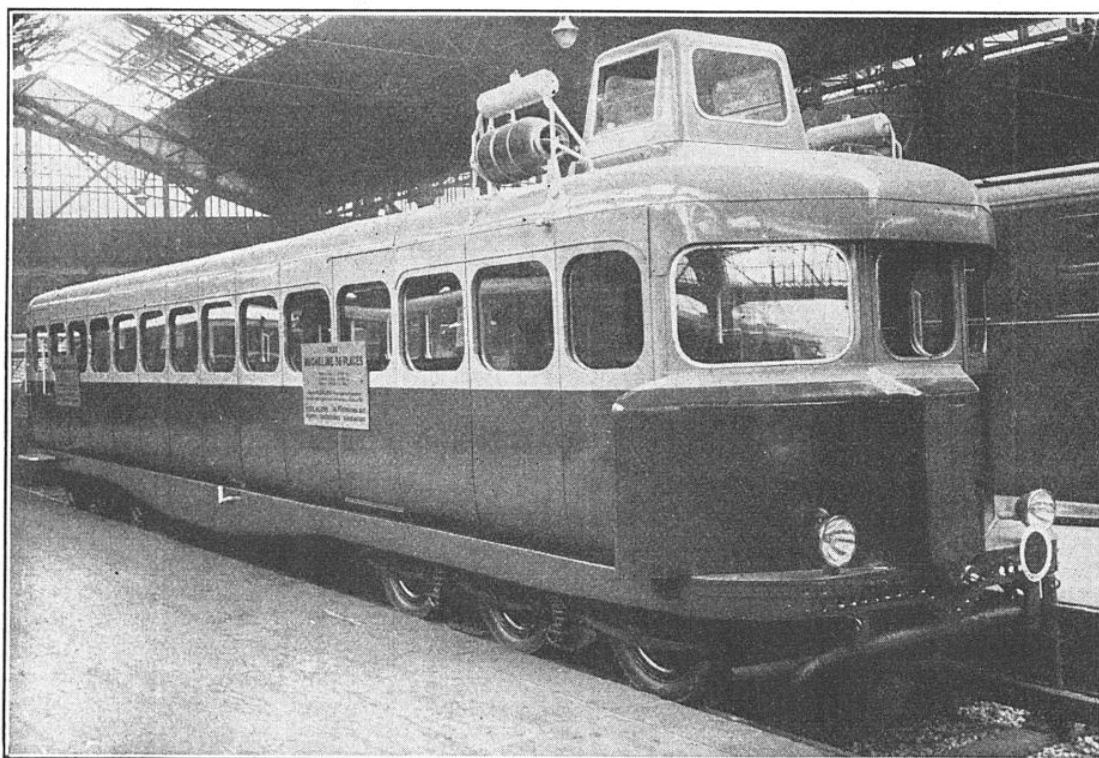
FIG. 3. — LA « MICHELINE » RÉVERSIBLE, 36 PLACES, A 12 ROUES « PNEURAIL »
