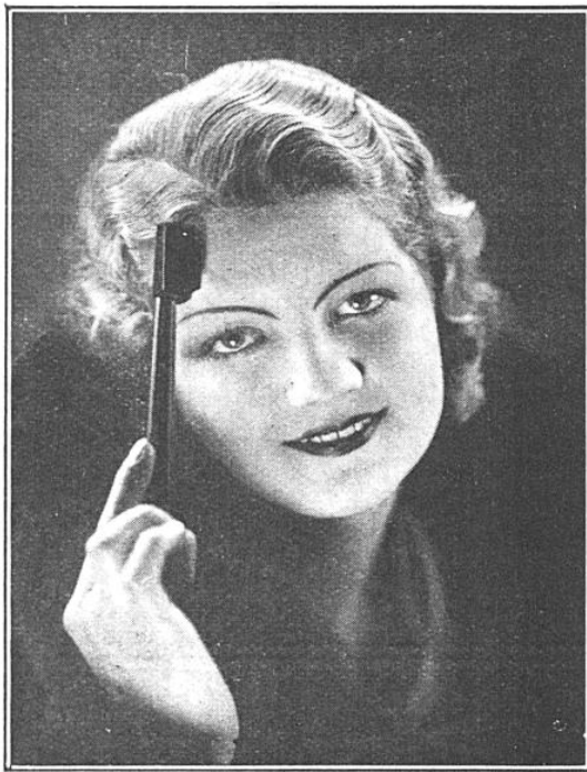
FIG. 4. — VOICI L'APPAREIL D'AUDITION PAR CONDUCTION OSSEUSE APPLIQUÉ SUR LE FRONT. Il est, dans ce cas, maintenu appliqué à la main, par un manche de face-à-main.
