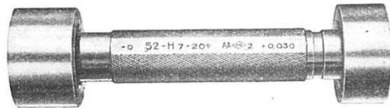
FIG. 3. — TAMPON DOUBLE POUR LA VÉRIFICATION DES ALÉSAGES NORMAUX
