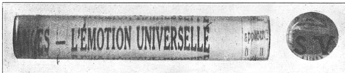
FIG. 2. — VOICI UN CYLINDRE EN « POLLOPAS », VERRE ORGANIQUE A BASE D'URÉE. On voit nettement, quand on le regarde soit latéralement, soit en bout, les caractères placés derrière lui, ce qui prouve que sa transparence est parfaite, comme celle du « Rhodoïd ».
