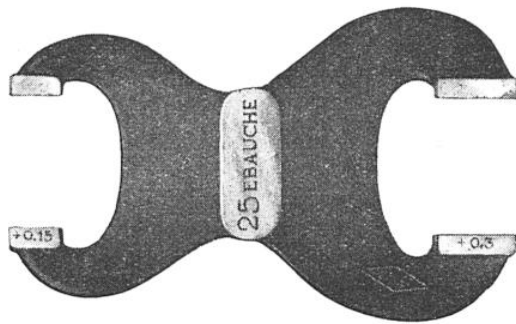
FIG. 1. — CALIBRE-MACHOIRE DOUBLE POUR LA VÉRIFICATION DES ARBRES
