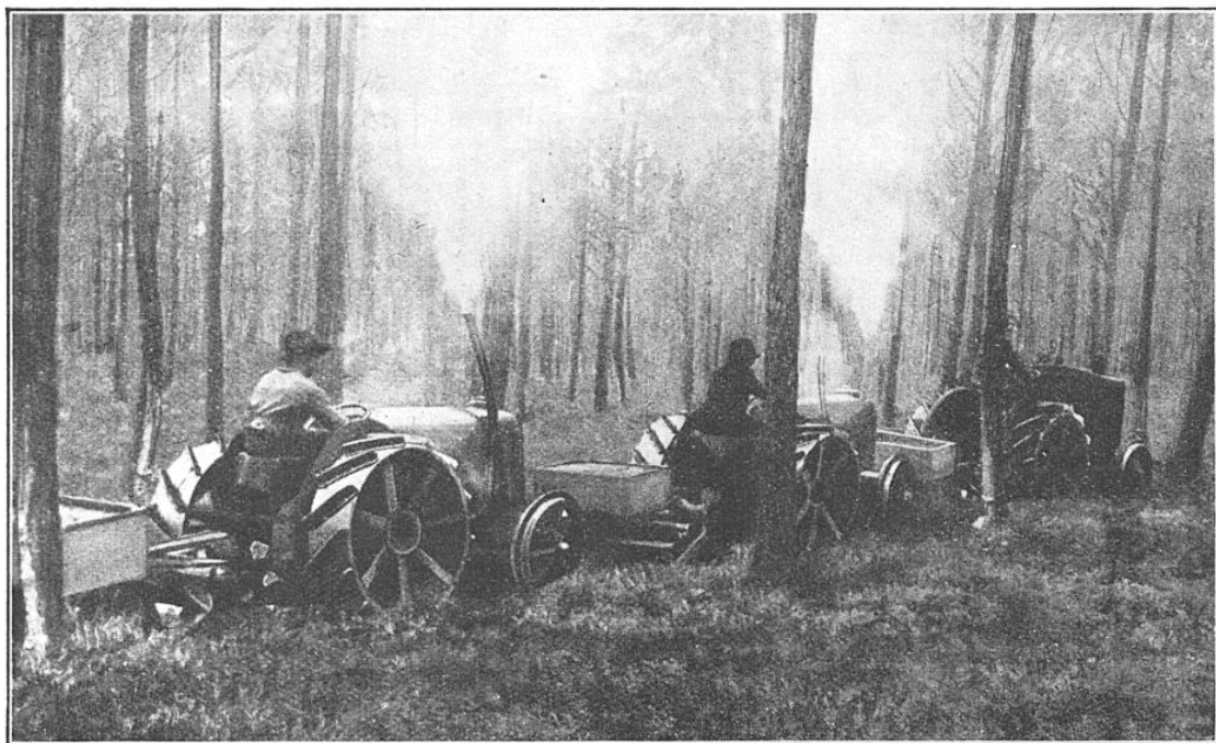
FIG. 2. — L'OPÉRATION MÉCANIQUE DU DÉBROUSSAILLAGE DANS LA FORÊT LANDAISE Voici les « débroussailleurs » modernes en action pour écraser les sous-bois et les hacher plus ou moins. Cette opération est destinée à dégager les jeunes semis de pins et à favoriser la croissance.
