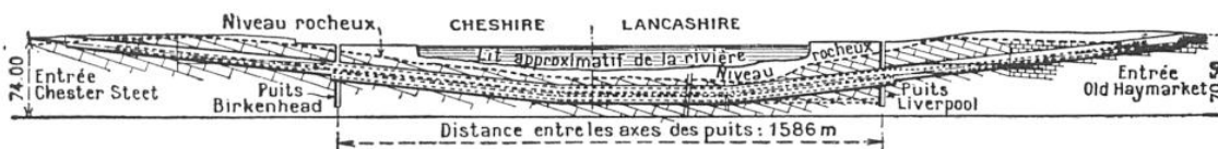
FIG. 1. — COUPE LONGITUDINALE DU TUNNEL DE LA MERSEY (LIVERPOOL)
