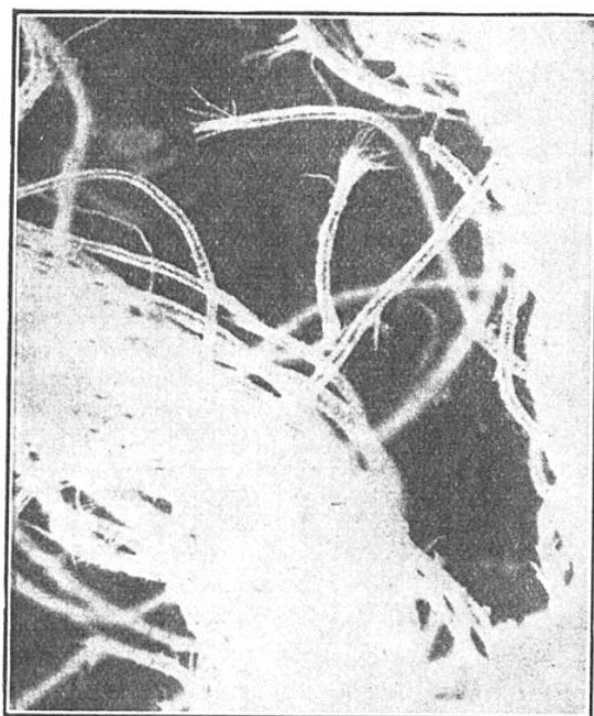
FIG. 8. — FIBRES DE LAINE ROMPUES La microphotographie révèle ici la cause pour laquelle un lot de laine ne pouvait donner une filature régulière et uniforme.
