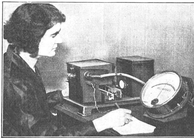
FIG. 4. — DÉTAIL DU PHOTOCOLORIMÈTRE (TOUSSAINT-PINTE) MONTRANT L'ESSENTIEL DE L'APPAREILLAGE. On aperçoit les écrans colorés à demi sortis de leur coffre. En face du pupitre à échantillon, à droite, le projecteur lumineux d'intensité. Dans le coffre se trouve la cellule photoélectrique, dont le courant actionne le milliampèremètre.
