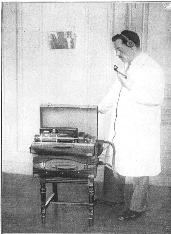
FIG. 5. — UN REPORTER EN VOYAGE EN TRAIN DE TRANSMETTRE UN BÉLIOGRAMME AU MOYEN DES DEUX VALISES DONT LA FONCTION EST DÉCRITE AUX PAGES 304 ET 305
