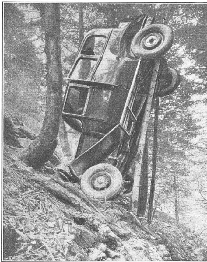
FIG. 10. — CURIEUSE PHOTOGRAPHIE MONTRANT LA SOLIDITÉ D'UNE VOITURE CARROSSERIE TOUT ACIER La caisse de cette voiture Citroën a résisté et les passagers sont sortis indemnes de cet accident, survenu dans les Vosges.
