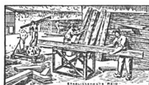
SCIE CIRCULAIRE en acier pour tronçonner les bûches et débiter en long. Un seul modèle. 480 fr. franco. (Notice 36)
