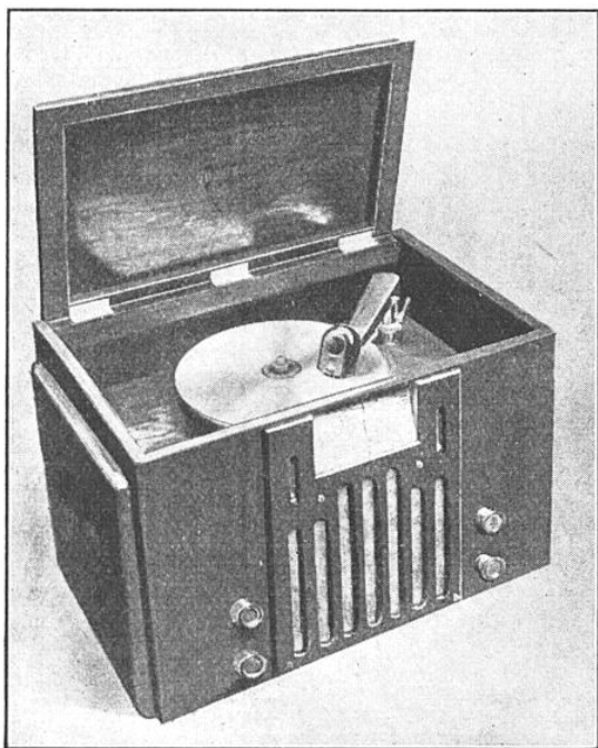
FIG. 12. — POSTE RÉCEPTEUR ENREGISTREUR Cet appareil permet non seulement la réception simple, mais rend également possible l'enregistrement de l'émission reçue. L'enregistrement amateur est également prévu. L'appareil permet de reproduire aussi bien les disques enregistrés par lui-même que les disques ordinaires de commerce.
