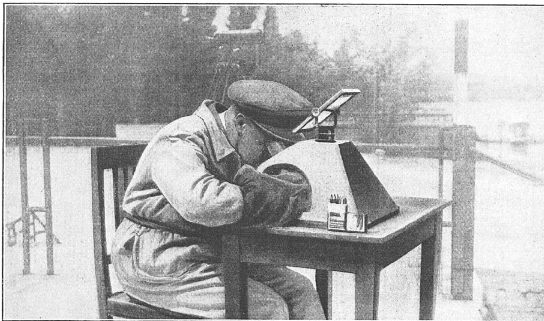
FIG. 5. — DISPOSITIF OPTIQUE POUR RELEVER LES VIRAGES DU SOL
