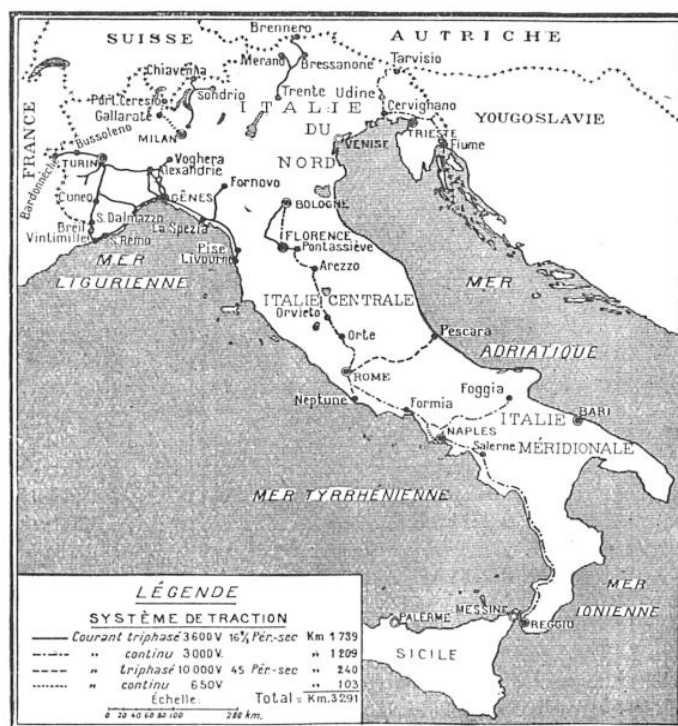
FIG. 2. — CE QUE SERA L'ÉLECTRIFICATION FERROVIAIRE EN 1936. LES MÊMES SYSTÈMES DE TRACTION SONT PRÉ-VUS (COURANTS ALTERNATIFS JUSQU'À 10.000 VOLTS)
