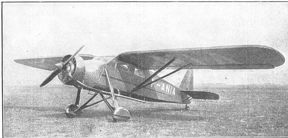
L'AVION DE TOURISME « SALMSON », TYPE « PHRYGANE », A TROIS PLACES, ÉQUIPÉ D'UN MOTEUR DE 135 CH A REFROIDISSEMENT PAR L'AIR. LE RAYON D'ACTION EST DE 1.000 KILOMÈTRES
