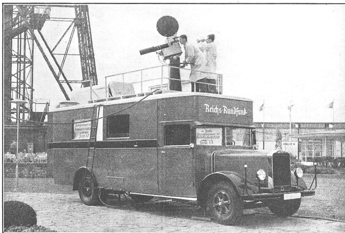
FIG. 4. — VUE EXTERIEURE DE LA VOITURE UTILISEE, POUR LA PRISE ET LA TRANSMISSION DE VUES PAR TELEVISION, PAR LA SOCIÉTÉ GOUVERNEMENTALE DE RADIODIFFUSION ALLEMANDE L'émetteur analyse les images par 180 lignes et 25 explorations par seconde.
