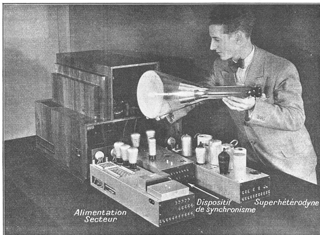
FIG. 3. — VUE INTÉRIEURE D'UN RÉCEPTEUR POPULAIRE DE TÉLÉVISION, ÉTABLI PAR LA MAISON LÖWE, AU MOMENT OU L'ON INTRODUIT LE TUBE CATHODIQUE
