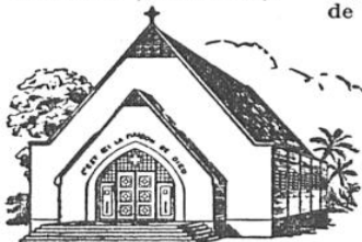
EGLISES ET TEMPLES COLONIAUX avec toiture en pente de 30 centimètres au mètre. (Notice 214)
