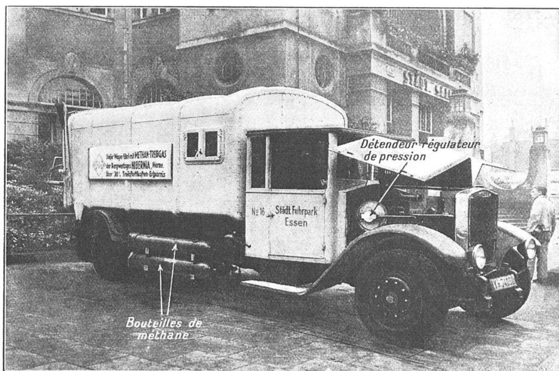
FIG. 3. — EN ALLEMAGNE, PLUSIEURS CENTAINES DE VÉHICULES UTILISENT MAINTENANT COMME CARBURANT LE MÉTHANE MIS EN BOUTEILLES SOUS HAUTE PRESSION
