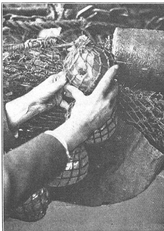
FIG. 6, 7 ET 8. — EN HAUT : LE « PRÉSIDENT-THÉODORE-TISSIER », NAVIRE-LABORATOIRE UTILISÉ PAR L'OFFICE NATIONAL DES PÊCHES. EN BAS À GAUCHE : LE GRAND CHALUT À droite : un flotteur de verre du chalut qui, immergé à 3.000 mètres, a été rempli par l'eau de mer devenue « douce » par filtrage à travers le verre. À la remontée, l'air comprimé à 300 atmosphères dans la sphère de verre l'a fait exploser en un point curieusement précis visible sur la photo.
