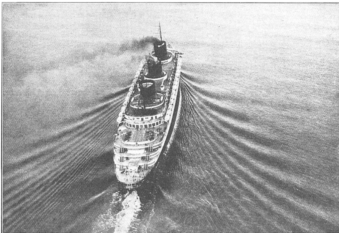
FIG. 3. — L'ONDE BALISTIQUE PRODUITE PAR UN PROJECTILE PEUT SE COMPARER AUX ONDES FORMÉES SUR UNE EAU CALME PAR LE SILLAGE D'UN NAVIRE
