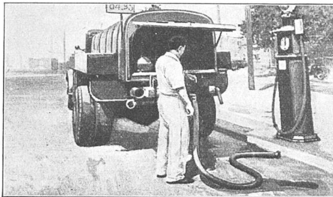
FIG. 3. — VOICI UNE INTÉRESSANTE APPLICATION, EN AMÉRIQUE, DU CAOUTCHOUC SYNTHÉTIQUE AU TRANSVASEMENT DES HYDROCARBURES
