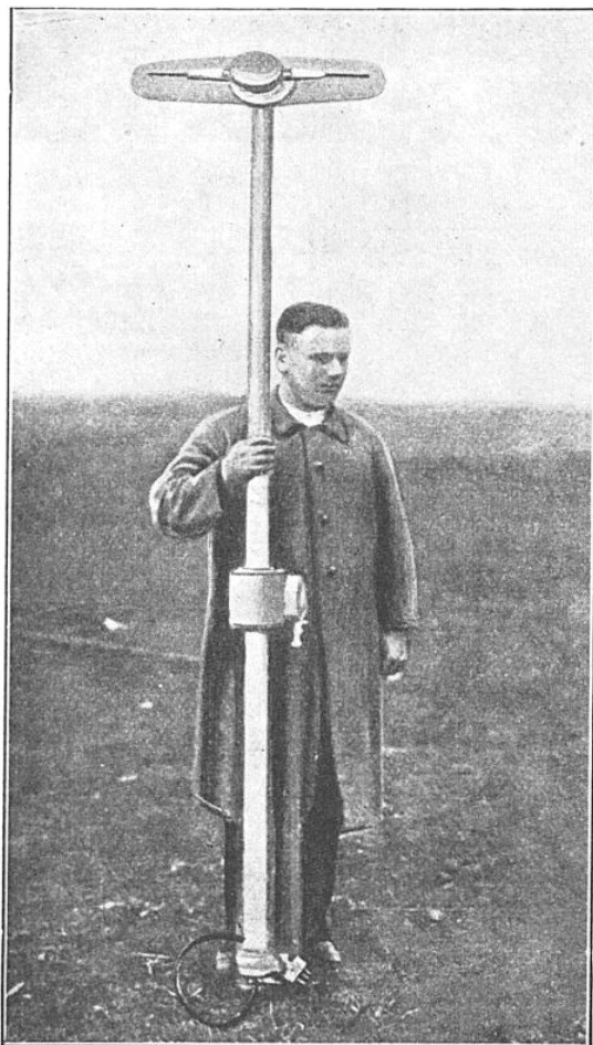
FIG. 2. — VOICI UN ÉMETTEUR A ONDES ULTRACOURTES (5 A 15 CM DE LONGUEUR D'ONDE) MONTÉ SUR POTEAU ET MUNI D'UN ÉCRAN RÉFLECTEUR DERRIÈRE L'ANTENNE
