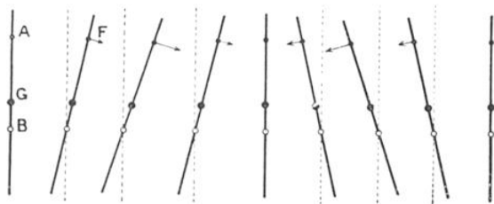
FIG. 2. — EFFORT PÉRIODIQUE APPLIQUÉ A UNE BARRE POUVANT SE DÉPLACER DANS LE SENS VERTICAL
