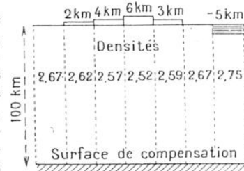
FIG. 4. — LA COMPENSATION ISOSTASIQUE DE PRATT
