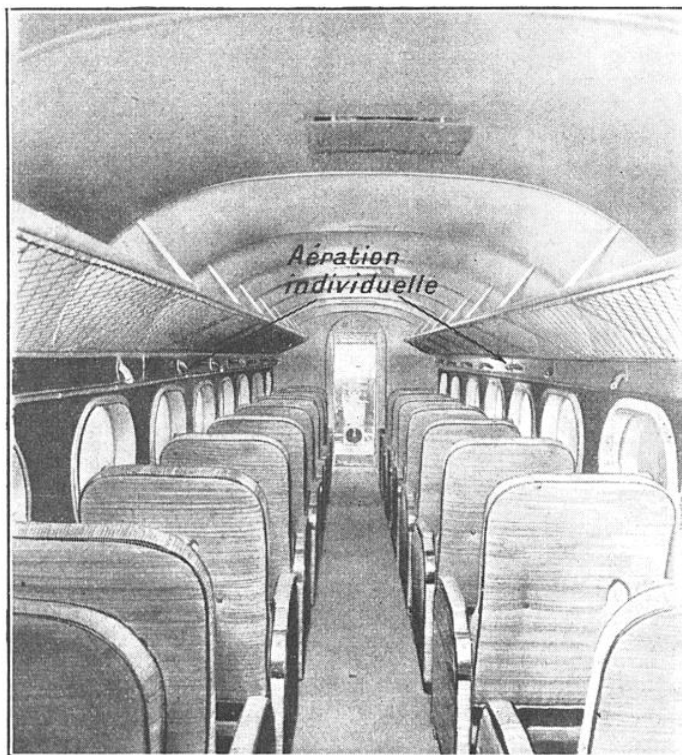
FIG. 10. — VUE DE LA CABINE A 18 PASSAGERS, TERMINÉE Remarquer les prises d'air pour l'aération individuelle. Les parois sont absolument étanches partout ailleurs.
