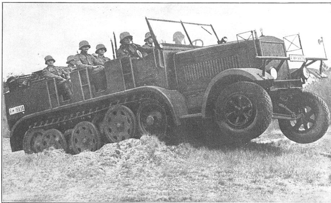
FIG. 4. — TRACTEUR A CHENILLES « TOUS TERRAINS » CONÇU POUR REMORQUER, SUR LES TERRAINS LES PLUS VARIÉS, LES PIÈCES DE 15 CM (VOIR LA PAGE PRÉCÉDENTE)
