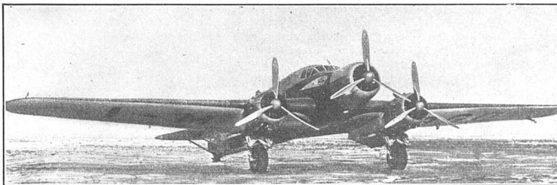
FIG. 4. — AVION « SAVOIA-MARCHETTI », TYPE « S.-79 », A TROIS MOTEURS PIAGGIO-STELLA DE 600 CH, AVEC HÉLICES TRIPALES A PAS VARIABLE EN VOL (ITALIE)
