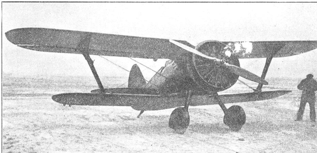
FIG. 2. — VOICI LE MONOPLACE DE CHASSE « I-15 », A MOTEUR « WRIGHT-CYCLONE » DE 700 CH A COMPRESSEUR, QUI, CONSTRUIT EN GRANDE SÉRIE, ÉQUIPE ACTUELLEMENT LES FORMATIONS AÉRIENNES DE L'ARMÉE SOVIÉTIQUE
