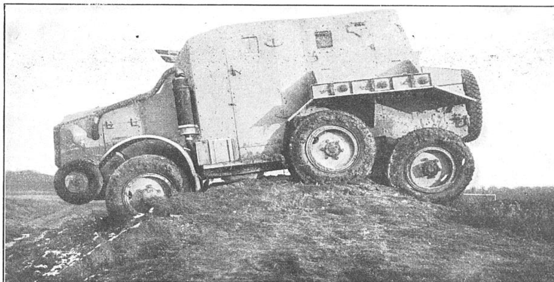
FIG. 3. — AUTOMITRAILLEUSE BLINDÉE A ADHÉRENCE TOTALE (SIX ROUES MOTRICES)
