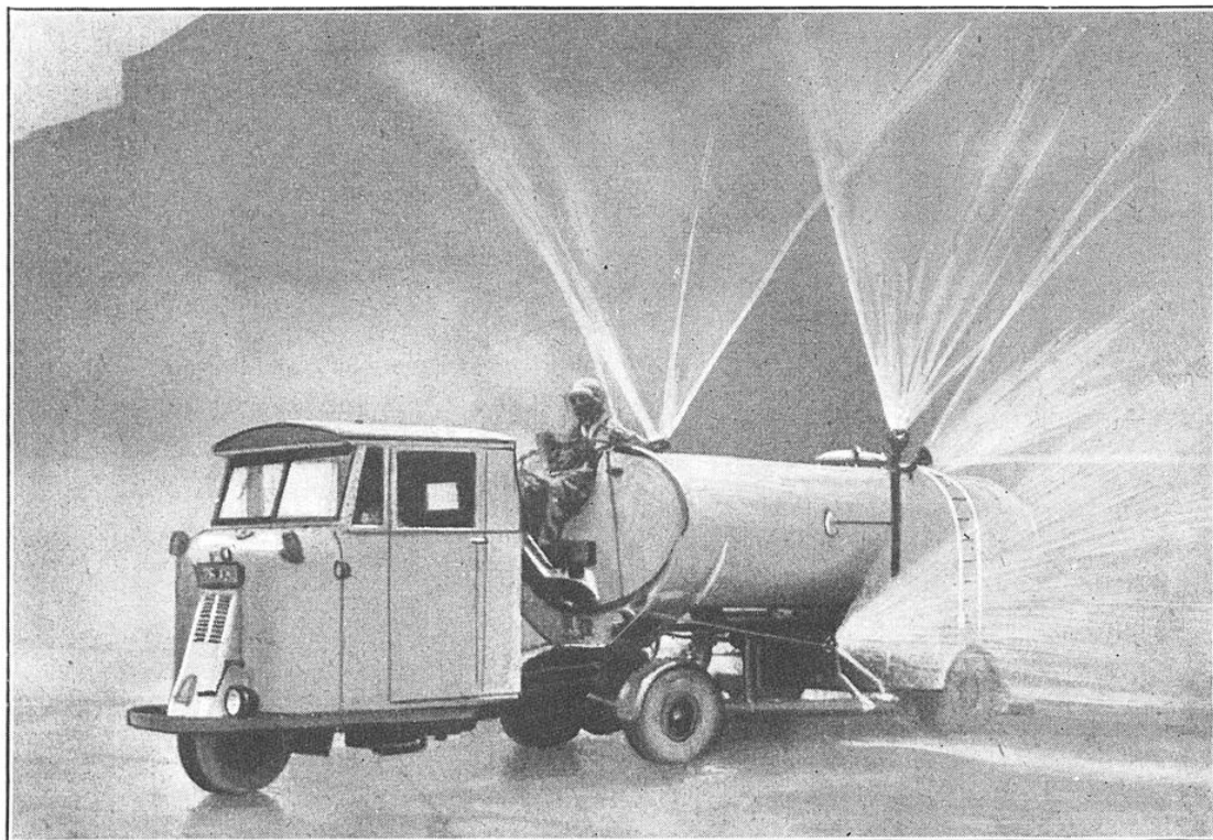
FIG. 7. — VOICI, EN ACTION, LE VÉHICULE QUI A ÉTÉ SPÉCIALEMENT ÉTUDIÉ, EN ANGLETERRE, POUR ASSURER LA DÉSINFECTION DES RUES ET DES FAÇADES DE MAISONS AU MOYEN DE NAPPES D'EAU ET DE JETS PUISSANTS (VOIR PAGE 129 DE CE NUMÉRO.)
