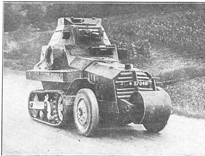
FIG. 5. — AUTOMITRAILLEUSE DE COMBAT, DU POIDS DE 6,2 T, ARMÉE D'UN CANON DE 37 MM ET D'UNE MITRAILLEUSE DE 7,5 MM
