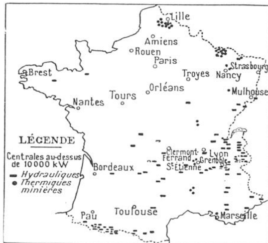
FIG. 6. — RÉPARTITION EN FRANCE DES CENTRALES HYDRAULIQUES ET THERMIQUES (INSTALLÉES SUR LES BASSINS MINIERES)
