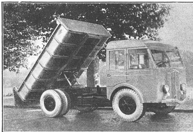
SUR CETTE BENNE BASCULANTE DE 4 M 3 (SOCIÉTÉ « LA LILLOISE »), L'EMPLOI RATIONNEL DU DURALUMIN A PERMIS DE GAGNER 580 KG PAR RAPPORT A LA CONSTRUCTION EN ACIER, CE QUI PERMET D'AMORTIR EN UN AN LE SUPPLÉMENT DE PRIX DU A L'EMPLOI D'ALLIAGES LÉGERS
