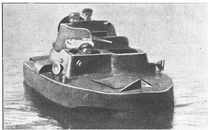
FIG. 2. — AUTOMOBILE BLINDÉE AMPHIBIE TYPE « FORD », CONSTRUITE EN U. R. S. S.
