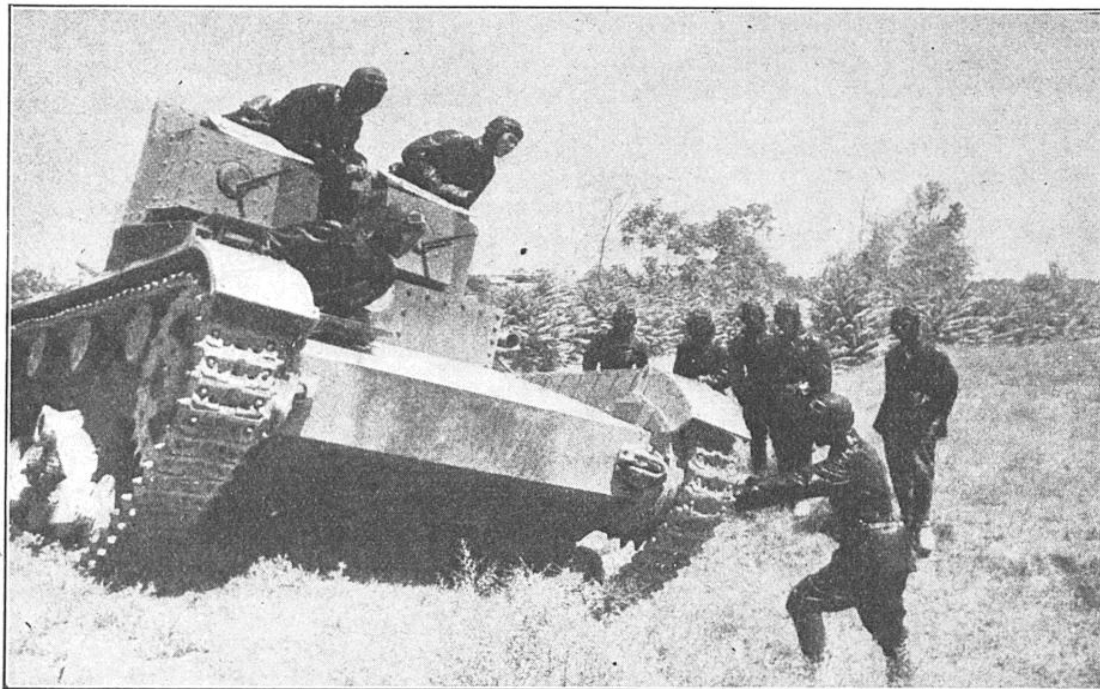
FIG. 4. — CHAR DE COMBAT RUSSE DE 7 TONNES MODÈLE « VICKERS-ARMSTRONG » (T 26) Ce char, qui dérive du modèle anglais Vickers Armstrong, est armé, soit de deux mitrailleuses de 7, 69 mm (6 000 coups en réserve), soit d'une mitrailleuse de 7,69 mm et d'une de 12, 7 mm (avec respectivement 3 000 et 1 000 coups en réserve). L'épaisseur du blindage est de 13 mm pour la tourelle et de 8 mm pour le corps du char. Le champ de tir horizontal est de 265°. La vitesse de cet engin est de 35 km/h, avec un moteur de 90 ch (à quatre cylindres horizontaux). Certains chars de ce type sont équipés de T. S. F. avec une antenne circulaire qui entoure la tourelle.
