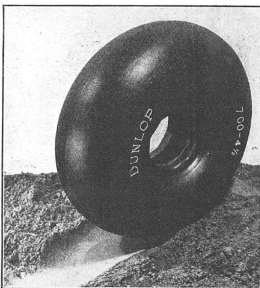
FIG. 4. — EXEMPLE DE PNEU DE ROUE DE QUEUE DU TYPE « SUPERBALLON » GONFLÉ A TRÈS BASSE PRESSION
