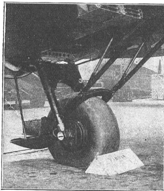
FIG. 3. — ATERRISSEUR MUNI DE PNEU A FAIBLE PRESSION, DE L'AVION « FARMAN-222 », TYPE « CENTAURE », PESANT 17 TONNES ET CAPABLE DE TRANSPORTER 40 PASSAGERS
