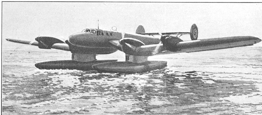
FIG. 8. — HYDRAVION ALLEMAND «HA-139», A FLOTTEURS, DE 16 TONNES
