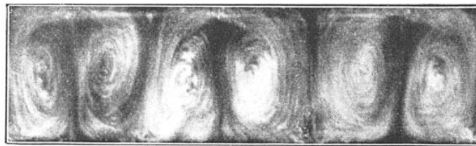
FIG. 11. — COUPE TRANSVERSALE DE TOURBILLONS CELLULAIRES CONVECTIFS DANS UN BAIN D'HUILE
