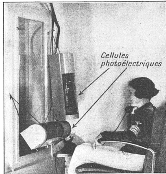
FIG. 3. — LA CABINE DE VISIOTÉLÉPHONIE DU PAVILLON DE L'ALLEMAGNE A L'EXPOSITION, REPRODUCTION EXACTE DE CELLES DE LEIPZIG, BERLIN, MUNICH ET NUREMBERG
