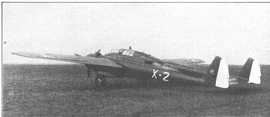
FIG. 2. — LE PREMIER APPAREIL ÉTUDIÉ SPÉCIALEMENT POUR REMPLIR LES MISSIONS DÉVOLUES À L'AVIATION D'ASSAUT : L'AVION BIMOTEUR, BIFUSELAGE, « FOKKER G.-1 »
