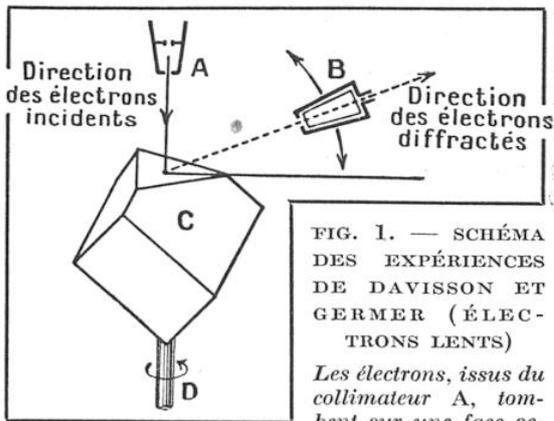
FIG. 1. — SCHÉMA DES EXPÉRIENCES DE DAVISSON ET GERMER (ÉLECTRONS LENTS)
