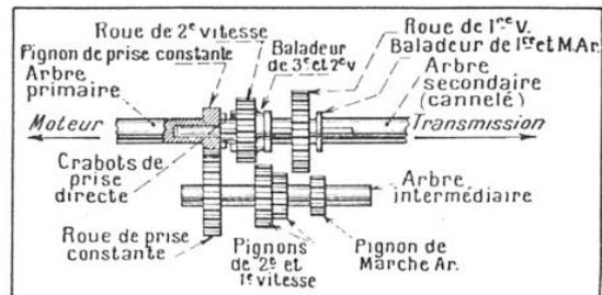
FIG. 4. — VOICI UNE AUTRE DISPOSITION DE BOITE A BALADEUR A TROIS VITESSES, DITE « A DEUX BALADEURS »
