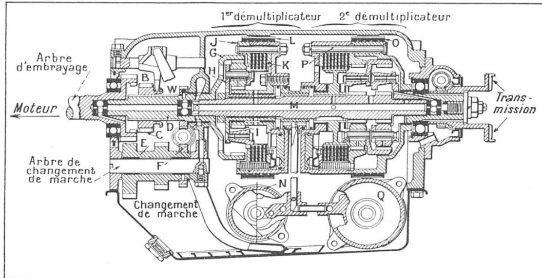
FIG. 9. — COUPE LONGITUDINALE DE LA BOÎTE DE CHANGEMENT DE VITESSE SEMI-AUTOMATIQUE INTÉGRALE « OLDSMOBILE-BUICK »
