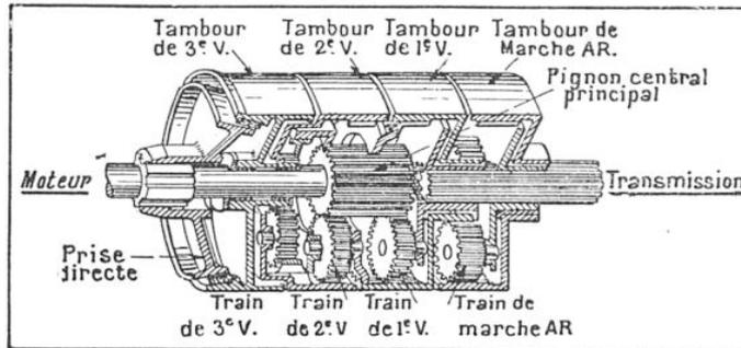
FIG. 8. — SCHÉMA DE LA BOITE DE CHANGEMENT DE VITESSE « WILSON » A PRÉSÉLECTION
