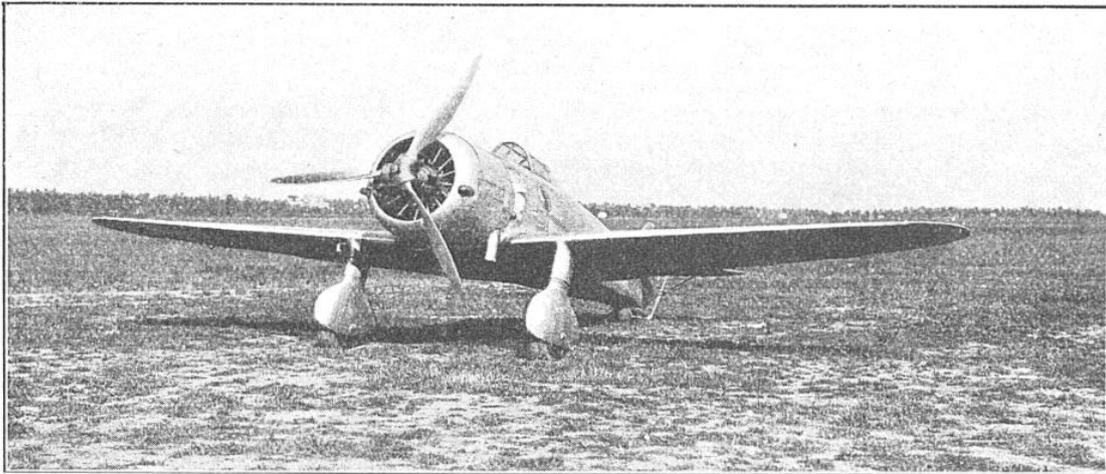
FIG. 5. — L'AVION DE CHASSE « RO.-51 » DE CONSTRUCTION MIXTE, A TRAIN FIXE
