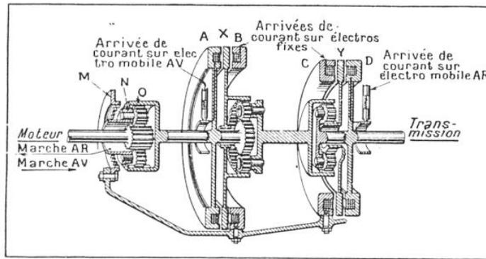
FIG. 6. — COUPE SCHEMATIQUE LONGITUDINALE DE LA BOITE ELECTROMECANIQUE « COTAL »
