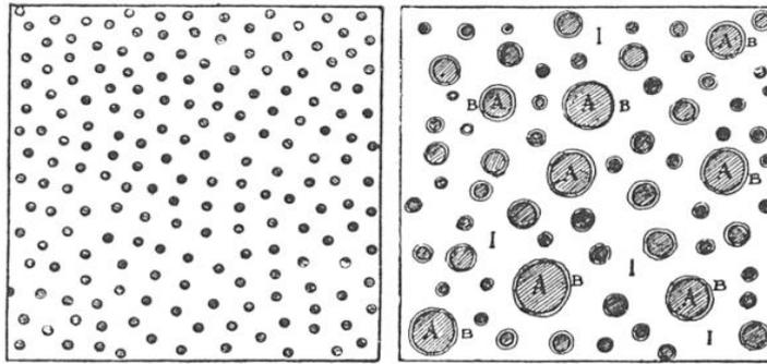
FIG. 4. — COMMENT SONT CONSTITUÉS UN COLLOÏDE MOLÉCULAIRE ET UN « MICELLOÏDE »
