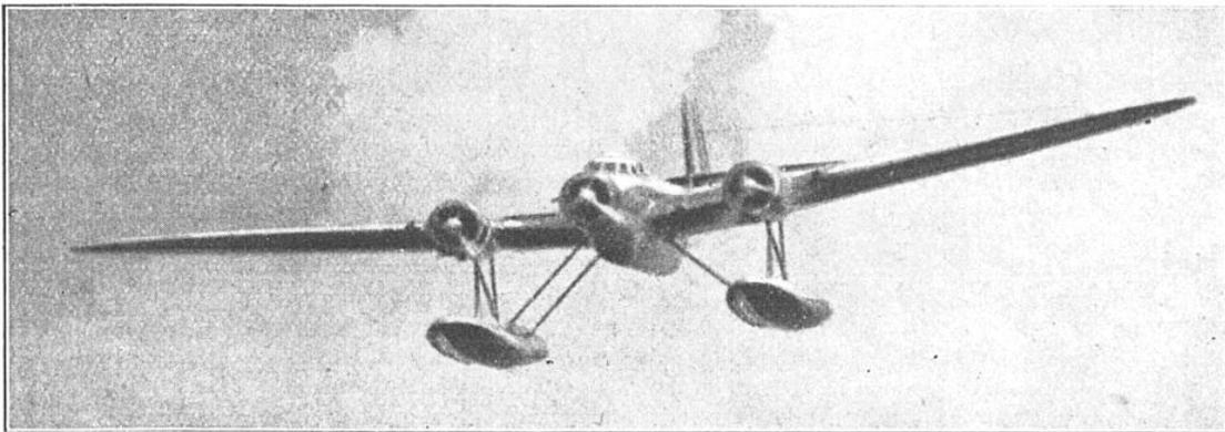
FIG. 3. - L'HYDRAVION « CANT 506-B », TRIMOTEUR ENTIÈREMENT EN BOIS (SAUF LES FLOTTEURS)
