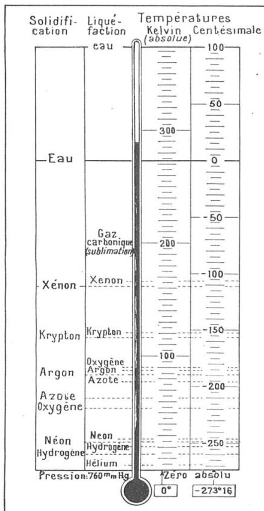
FIG. 3. — ÉCHELLE DES TEMPÉRATURES (ABSOLUES ET CENTÉSIMALES) DE LIQUÉFAC-TION ET DE SOLIDIFICATION DE QUELQUES GAZ
