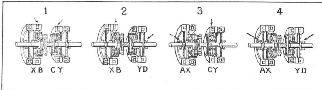
FIG. 7. — COMMENT S'EFFECTUENT LES LIAISONS ENTRE LES DIFFERENTS ELEMENTS DE LA BOITE « COTAL » SUIVANT LES COMBINAISONS DE VITESSE DESIRÉES
