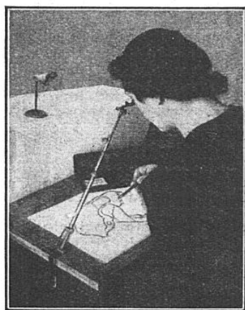
COMMENT ON REPRODUIT UN SUJET EN L'AGRANDISSANT AVEC LA « CHAMBRE CLAIRE UNIVERSELLE »
