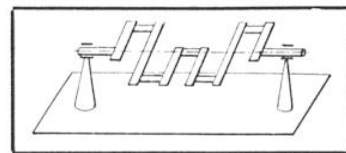
FIG. 4. — SCHÉMA D'UN VILEBREQUIN SYMÉTRIQUE DE MOTEUR A 4 CYLINDRES
