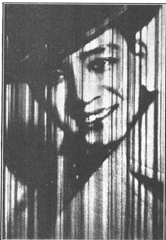
FIG. 1. — INFLUENCE DU FADING SUR LA TRANSMISSION D'IMAGES PAR LA MODULATION ORDINAIRE EN AMPLITUDE
