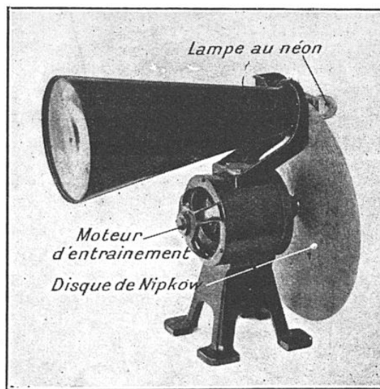
FIG. 9. — LE PREMIER RÉCÉPTEUR DE TÉLÉVISION BARTHÉLÉMY
