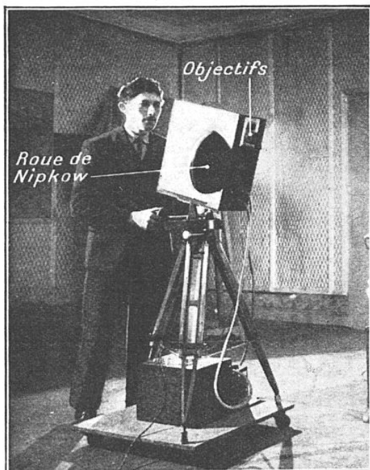
FIG. 1. — PRISE DE VUE DANS LE STUDIO DE LA COMPAGNIE FRANÇAISE DE TÉLÉVISION AU MOYEN DE LA CAMERA A ROUE DE NIPKOW, SYSTÈME BARTHÉLEMY. L'EXPLORATION DU SUJET EST INFÉRIEURE A 180 LIGNES
