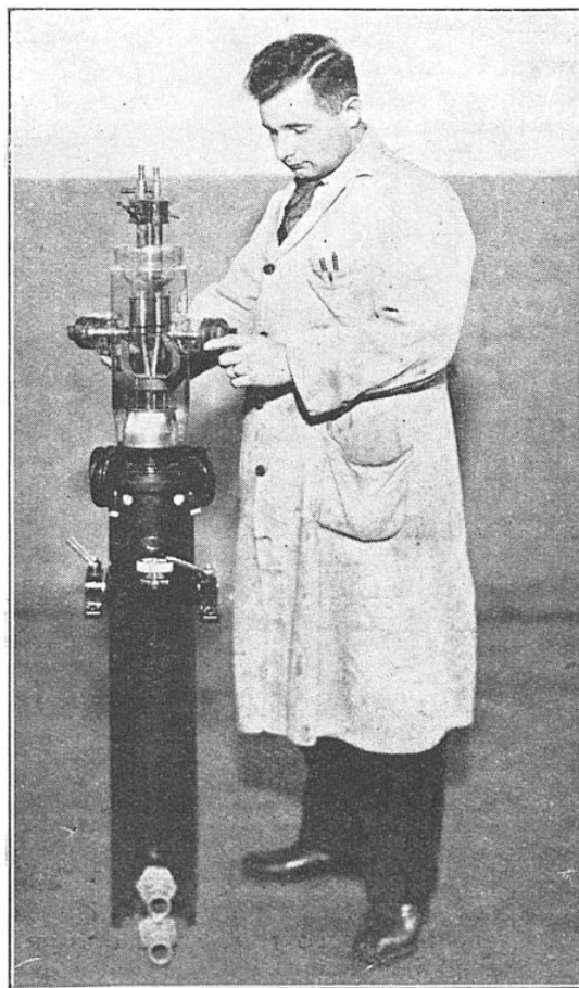
FIG. 6. - CETTE TRIODE DE 250 kW A CIRCULATION D'EAU MESURE ENVIRON 1 M 50 DE HAUT
