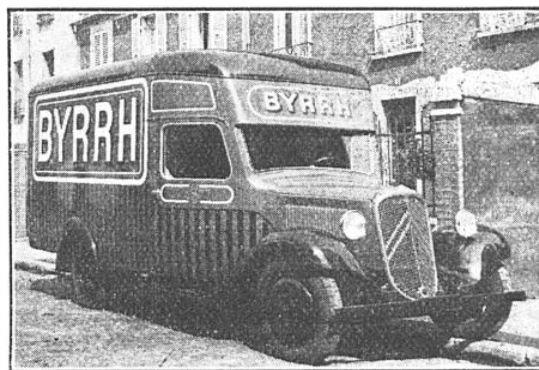
FIG. 3. — FOURGON « CITROËN-23 » DONT LE POIDS DE LA CAISSE A ÉTÉ RAMENÉ DE 800 A 400 KG GRACE AUX ALLIAGES D'ALUMINIUM L'augmentation de charge utile résultant de l'allégement (400 kg sur 1 500 kg) est de 20,6 %.
