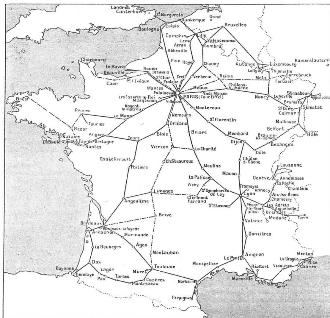
FIG. 11. — CARTE DU RÉSEAU DES CABLES SPÉCIAUX QUI RELIENT LES ÉMETTEURS ET LES STUDIOS DU RÉSEAU D'ÉTAT FRANÇAIS DE RADIODIFFUSION
