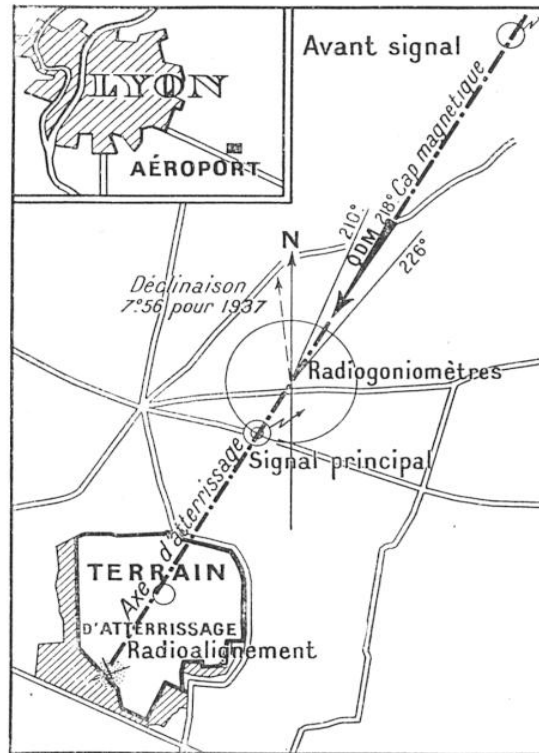
FIG. 8. — DISPOSITIF DE RADIOALIGNEMENT DE L'AÉROPORT DE LYON
