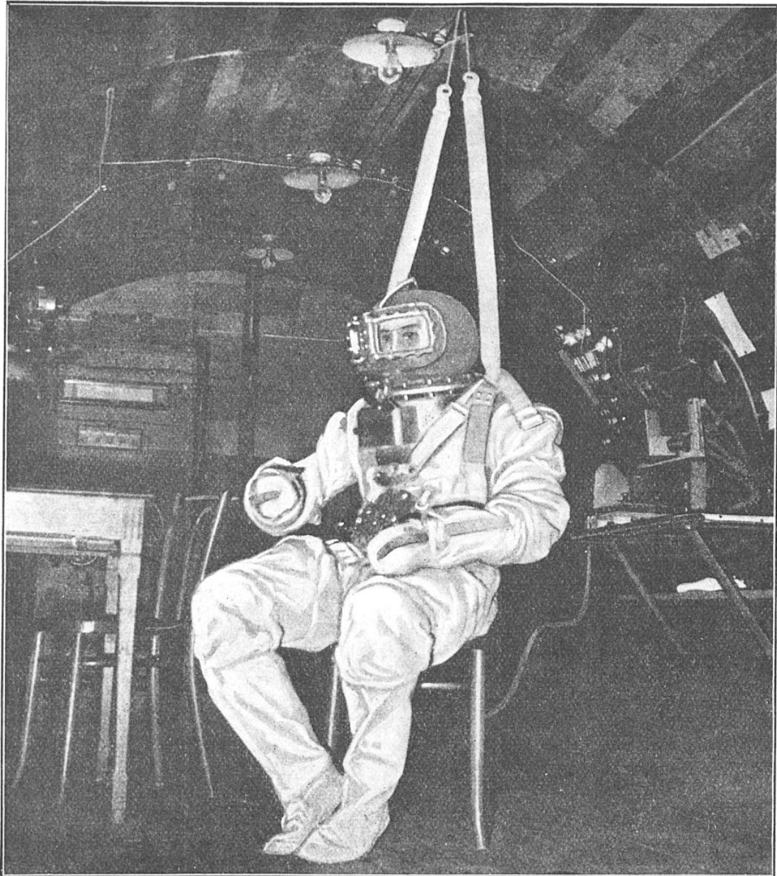
LE SCAPHANDRE STRATOSPHERIQUE DES DOCTEURS ROSENSTIEL ET GARS AUX, EN ESSAI DANS LE CAISSON PNEUMATIQUE DU BOURGET, PRÈS PARIS
