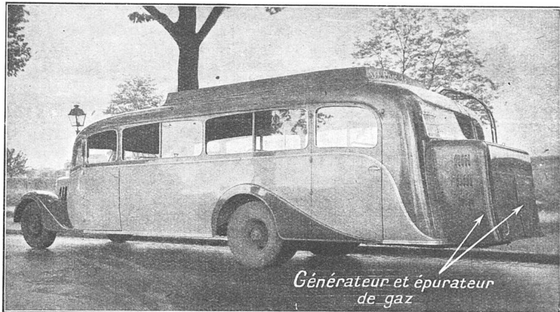
FIG. 1. — AUTOCAR ÉTUDIÉ POUR LA MARCHÉ AU GAZ DE GAZOGÈNE
