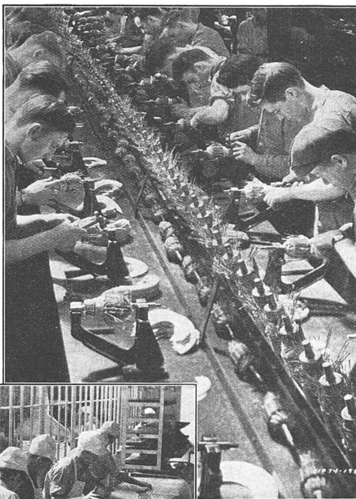
FIG. 8. — LA CHAÎNE DE MONTAGE DES INDUCTS DE DYNAMOS CHEZ FORD Les inducts sont bobinés à la machine et seules les connexions du bobinage avec le collecteur sont faites à la main.
