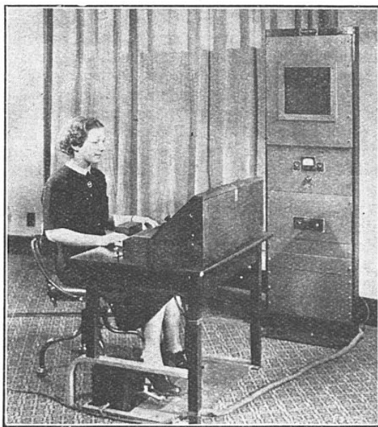
FIG. 13. — LE « VODER », MACHINE PARLANTE ÉLECTRIQUE, PERMETTANT LA SYNTHÈSE DE TOUS LES SONS ET DE LA PAROLE HUMAINE
