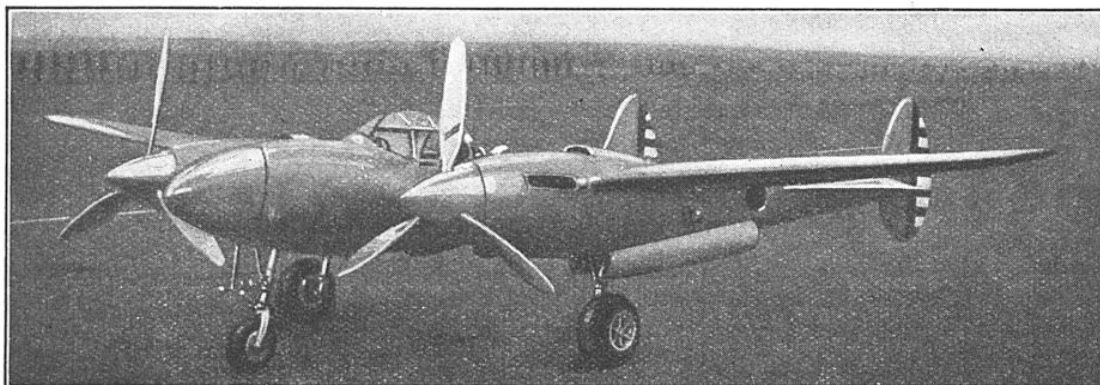
FIG. 6. — LE BIMOTEUR MONOPLACE DE CHASSE « LOCKHEED XP.-38 »
