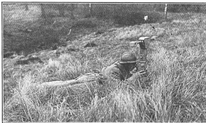
FIG. 5. — TÉLÉMÈTRE PÉRISCOPIQUE DE 80 CM DE BASE, UTILISÉ PAR L'INFANTERIE
