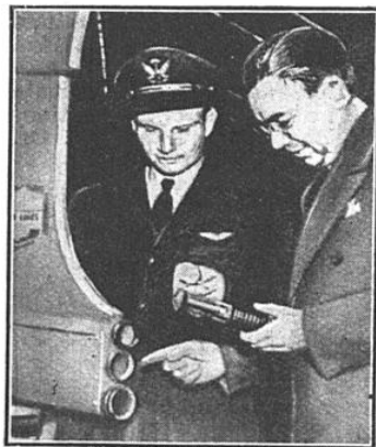
FIG. 9. — ALVÉOLES A L'ARRIÈRE DE L'AVION ET FUSÉE ASSURANT LE DÉROULEMENT DU FIL D'ACIER
