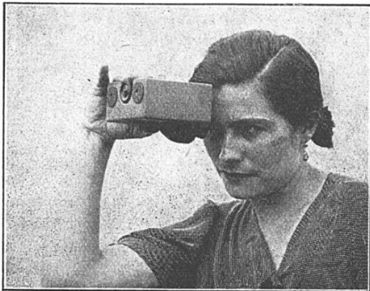
FIG. 3. — TÉLÉMÈTRE PORTATIF DE 75 MM DE BASE POUR FAIBLES DISTANCES
