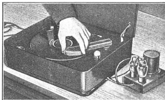
FIG. 6. — UNE DES DERNIÈRES NOUVEAUTÉS AMÉRICAINES : LE PICK-UP ÉMETTEUR
