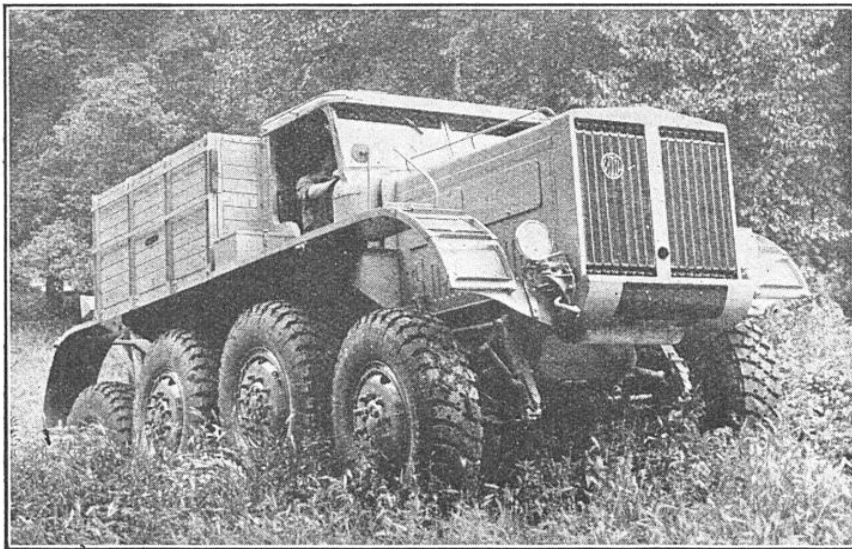
FIG. 8. — TRACTEUR « LATIL » DESTINÉ A REMORQUER DES CHARGES TRÈS ÉLEVÉES EN TERRAINS VARIÉS
