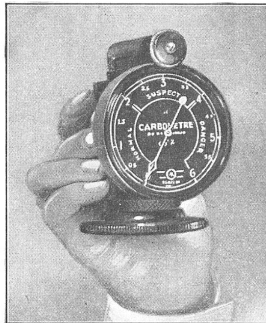
FIG. 8. — VUE EXTÉRIEURE DU CARBOMÈTRE GENAUD UTILISÉ POUR MESURER LE CONFINEMENT DES ABRIS
