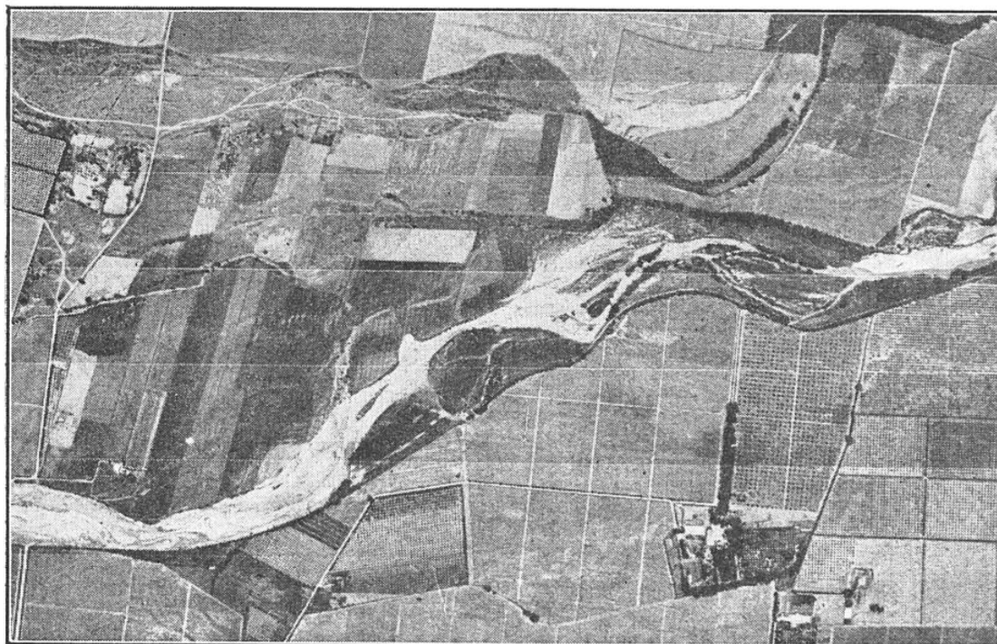
FIG. 6. — PLAN PHOTOGRAPHIQUE RESTITUÉ PAR LA MÉTHODE DU SCINTILLEMENT
