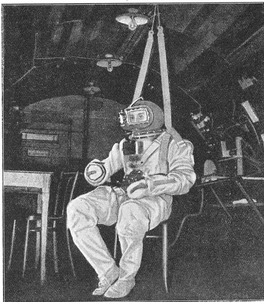
FIG. 7. — LE SCAPHANDRE AÉRIEN ROSENSTIEL ET GARSAUX T W 2979
