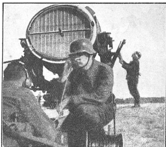
FIG. 7. — UN PROJECTEUR DE D.C.A. ALLEMAND Le servant, au téléphone, transmet les ordres d'allumage et de pointage sur les indications du poste d'écoute au son et du poste d'observation éloigné.
